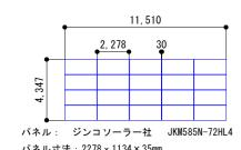
パネル寸法: 2278 x 1134 × 35mm パネル間隙間:横方向30mm 縦方向30mm
